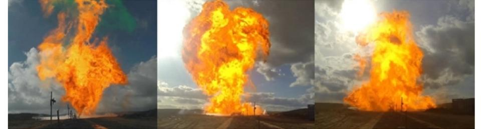
Рисунок 2 — Реализация огненного шара спустя 3 секунды после зажигания облака горючей смеси (заполнение 37 %, 67 % и 69 % соответственно) [3]
